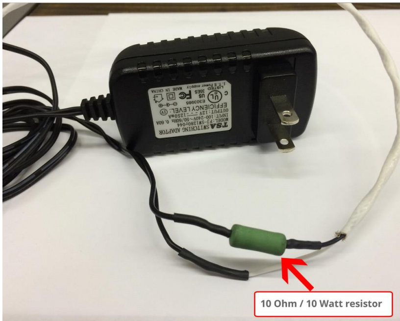
Afbeelding 6 – De SkyBell zonder deurbel schel aansluiten op een losse adapter (niet meegeleverd)
