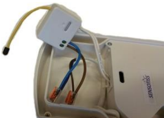
Afbeelding 6. De ingebouwde e-Domotica sensor
