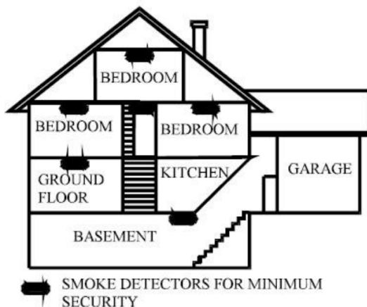
Afbeelding 8 – Aanbevolen montagelocaties voor rookmelders in een woning
